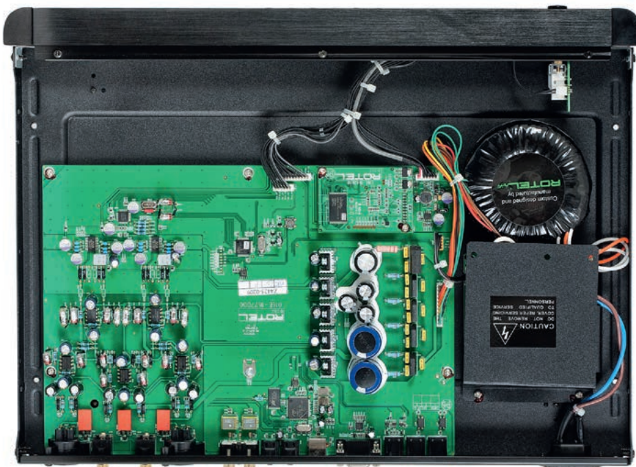
Duża obudowa daje duże możliwości; bez problemu zmieścił się tutaj bardzo solidny zasilacz.
