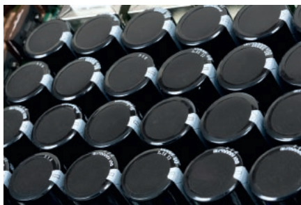
Duża bateria małych kondensatorów filtrujących – jedna z głównych zmian wprowadzonych w obecnie produkowanym modelu.
