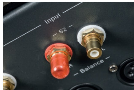
Gniazda RCA zabezpieczono gumowymi nasadkami.
