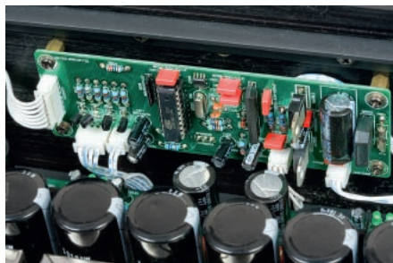
Blok sterujący odsunięto od zaekranowanego zasilacza.
