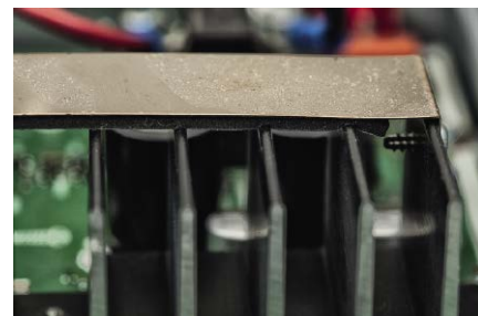
Miło popatrzeć na takie detale: na niewielkie radiatory (końcówek mocy) naklejono paski tłumiące wibracje.
