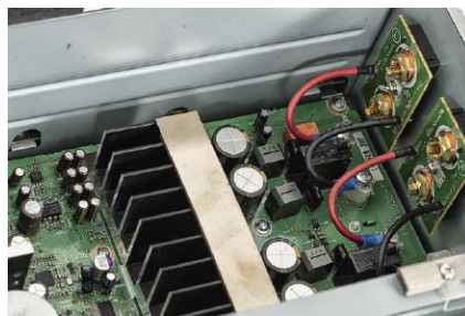
Końcówki mocy to autorskie opracowanie Technicsa z układem JENO Engine, który prowadzi większość cyfrowych operacji.
