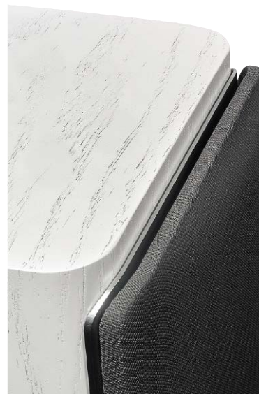
To rutynowe zdjęcie tym razem wyjaśnia bardzo wiele. Wyraźnie zaoblono pionowe krawędzie, dodano panel z aluminium, który przed „skorupę” z MDF-u wychodzi tylko na 4 mm, ale wchodzi do wnętrza na głębokość 10 mm. Maskownica na cienkiej ramce (wpływ na charakterystykę tylko minimalny) jest trzymana przez magnesy.
