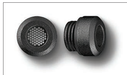
Filtr mechaniczny, czyli siateczka osłaniająca, zabezpieczając przed dostaniem się z zewnątrz obiektów większych niż... w kole o średnicy 2 mm (na zdjęciu czterokrotnie powiększenie) wykonano 55 sześciokątnych otworków. Filtr możemy sami odkręcić, aby go wyczyścić.
