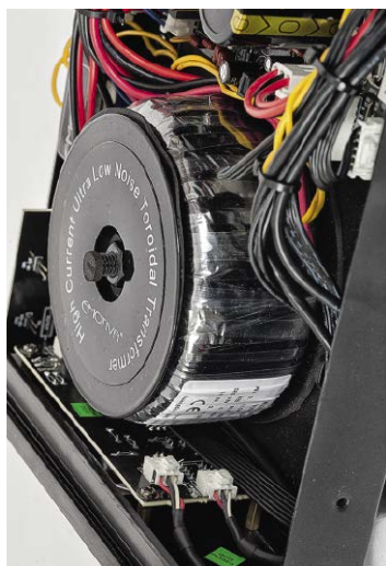
Transformator toroidalny to rarytas w tak niedrogim wzmacniaczu.
