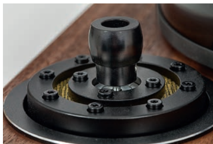
Choć wydaje się, że rolki napędowe są dwie, to pasek mocujemy na stałe w górnej części, a zmianę prędkości obrotowej realizuje układ elektroniczny.
