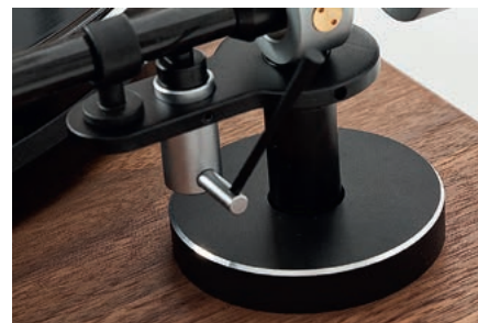
Podstawa ramienia jest metalowa; luzując śrubę blokującą, można łatwo wyregulować VTA.
