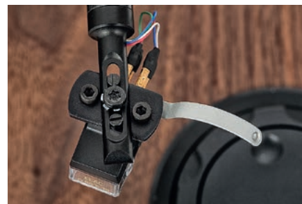
Wkładkę przykręcono dwoma śrubami do metalowej płytki, a dopiero później, pojedynczym torxem do rurki ramienia.
