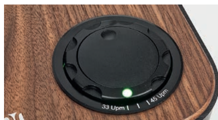
Do obsługi wszystkich funkcji przygotowano moduł dwóch pokręteł: zewnętrzne włącza i wyciąga napęd dla bazowych prędkości, wewnętrzne pozwala na dodatkową, płynną regulację w zakresie +/- 5% (prędkości nominalnej). Moduł regulacyjny spełnia także funkcję sygnalizatora obrotów, zielony kolor oznacza prędkość niższą (względem nominalnej). Dopiero kolor biały potwierdza idealną stabilność i precyzję obrotów, 33,3 lub 45 obr./min
