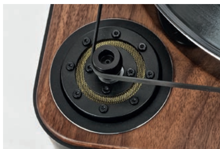
Gramofon ma napęd paskowy, silnik prądu stałego odsprężniono od ramy z MDF-u tulejkami z materiałem tłumiącym.
