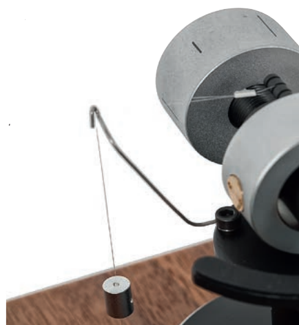
Układ anti-skatingu z ciężarkiem na żyłce to chyba najbardziej popularne i w regulacji bezproblemowe rozwiązanie. Przeciwwagę w postaci walca wkręcono w tylną sekcję rurki ramienia, nie ma wprowadzić skali, ale instrukcja daje precyzyjne wskazówki
