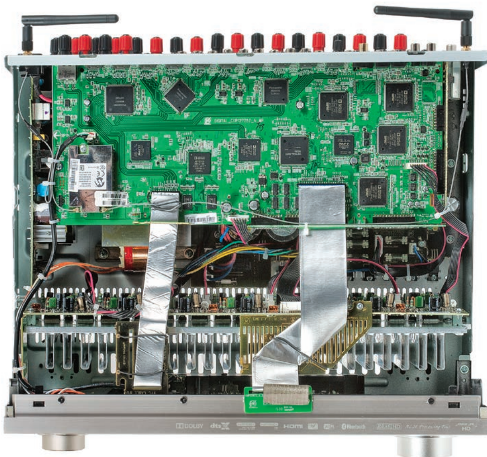
Typowa „piętrowa” konstrukcja amplitunera AV. Tranzystory kanałów mocy znalazły się w komplecie na jednym dużym radiatorze zamocowanym wzdłuż przedniego panelu.
