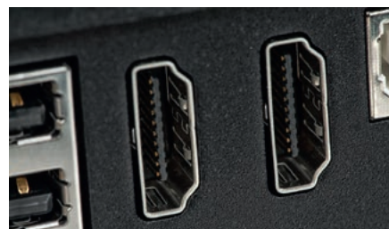
Dwa z gniazd wyglądają na popularne HDMI; faktycznie taki jest standard złącz, ale sama transmisja danych (I2S) ogranicza się do dźwięku i będzie aktywowana dopiero w przyszłości.
