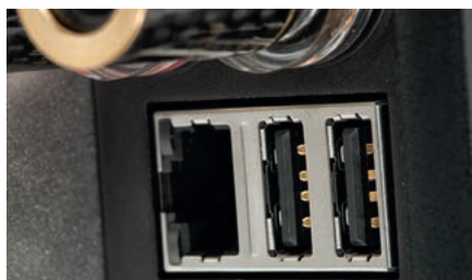
Sieć LAN pozwala na sterowanie wzmacniaczem za pomocą aplikacji, która daje też dostęp do funkcji strumieniowych. Jednak do działania w zwykłym trybie wzmacniacza wystarczy pilot lub przyciski na samym urządzeniu.
