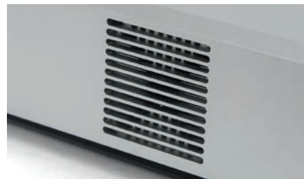
Niekonwencjonalnie rozwiązano chłodzenie wzmacniacza – wewnątrz pracuje wentylator, który przepycha powietrze przez szczeliny w bocznych ściankach.
