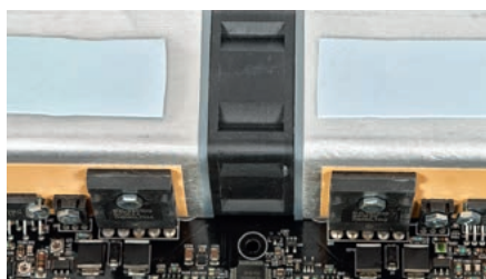
Końcówki mocy pracują w klasie AB, tranzystory mocy umieszczone na niskim, tunelowym radiatorze.
