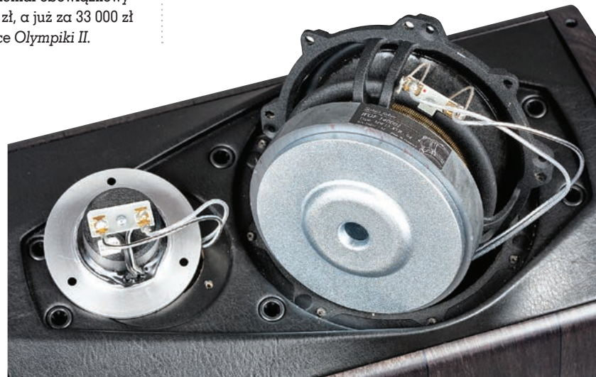
Magnesy duży i mały – głośnik wysokotonowy ma magnes neodymowy, więc nie należy narzekać na jego wielkość, ale specjalnie można cieszyć się z 11-cm magnesu 15-cm głośnika nisko-średniotonowego.
