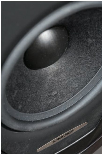
W centrum celulozowej membrany znajduje się bardzo lekka nakładka przeciwpyłowa, wykonana z takiego samego materiału tekstylnego, z jakiego są szykowane kopułki wysokotonowe.
