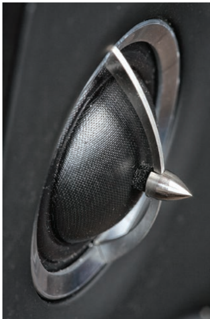
Problemem „miękkich” kopulek jest słaba kontrola ruchu centrum membrany, w tym przypadku najbardziej oddalonego od cewki. Sonus znalazł własne rozwiązanie przypominające do pewnego stopnia działanie przetworników pierścieniowych – centrum kopułki jest tłumione przez małątki walec z gąbki, przytrzymywany przez „korektor fazy”.
