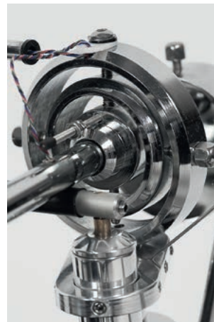
Rurka ramienia wchodzi w masywną tuleję, która jest zamocowana w precyzyjnych łożyskach zawieszania.
