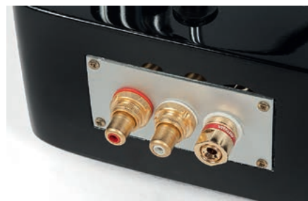
Przewody sygnałowe doprowadzono do płytki z tyłu obudowy, na której zamontowano komplet porządkowanych gniazdek – także dla żyty uziemiącej.
