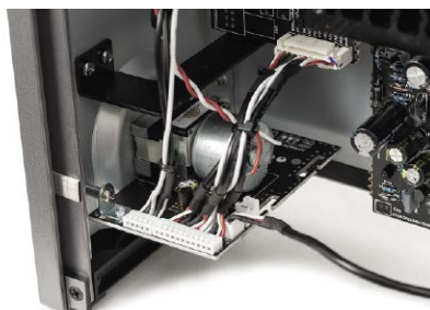
Pomimo nowoczesnych "wkładek", CXA81 ma klasyczny regulator głośności, wykorzystywany w produkcji coraz rzadziej.
