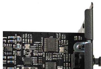
Jedną z nowości w modelu CXA81 (względem poprzednika) jest przetwornik DAC ESS Technology, który zastąpił Wolfsona.
