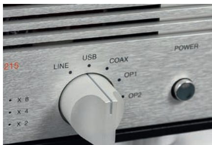
Selektor wejść jest mechaniczny, duże pokrętko ma klasyczny krój i jest wygodne.
