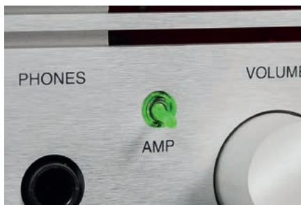
Akrylowy trzpień hebelka jest podświetlony na zielono lub czerwono, w zależności od trybu pracy, jako DAC i przedwzmacniacz, lub sam DAC (z wyjściem nieregulowanym).
