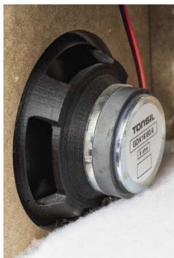
16-cm nisko-średniotonowy jest modelem produkowanym przez Tonsil tylko na potrzeby Bolero 300 .
