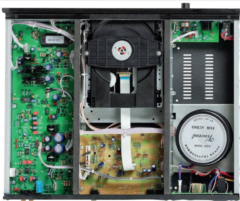
Wnętrze podzielono na trzy funkcjne komory. Toroidalny transformator ma dodatkowy „płaszcz” ekranujący.
