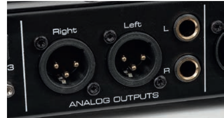
Podstawowe wyjście analogowe to zbalansowane XLR-y, sygnał niezbalansowany uzyskamy za pomocą pary złącz TS (popularny 6,3-mm jack w odmianie mono).
