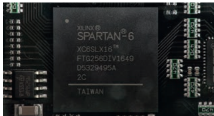
Za operacje cyfrowe odpowiadają procesory DSP; jeden z nich to potężny układ Xilinx Spartan 6.
