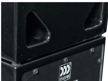
Bookshelf to samodzielny monitor, dla skuteczniejszego przetwarzania niskich częstotliwości również jego obudowa pracuje jako bas-refleks; dwa tunele o przekroju trójkątnym wyprowadzono na tylnej ściance.
