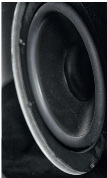
Na zewnątrz promieniuje tylko jeden głośnik, drugi taki sam znajduje się bezpośrednio za nim, tworząc system typu Isobaric , pozwalający dwukrotnie zmniejszyć objętość obudowy (przy osiągnięciu założonej charakterystyki).
