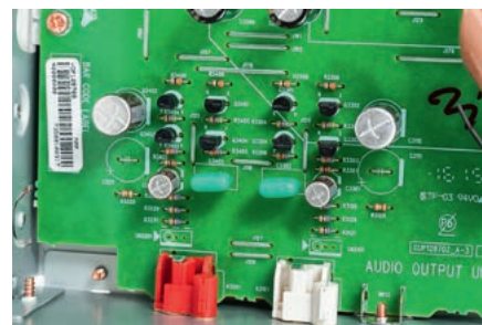
Sygnaly dla wyjść analogowych przygotowują wyłącznie elementy dyskretnie.
