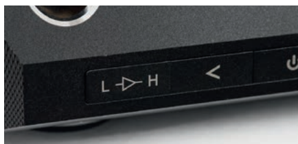
Oryginalny przełącznik trybów czułości pozwala na wybór jednego z dwóch (dla wyjść liniowych) lub aż czterech (słuchawkowych) ustawień.
