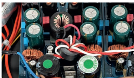
Koniecznym „składnikiem” wzmacniacza impulsowego jest pasywny filtr wyjściowy.
