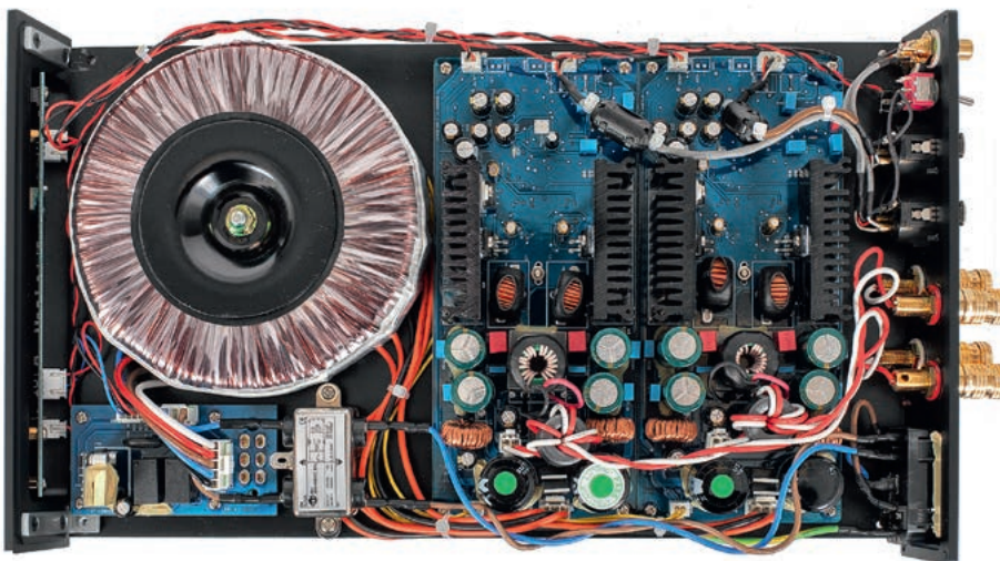
Konstrukcja ST-10 jest złożona z dwóch modułów końcówek, uzupełnionych dużym transformatorem toroidalnym.
