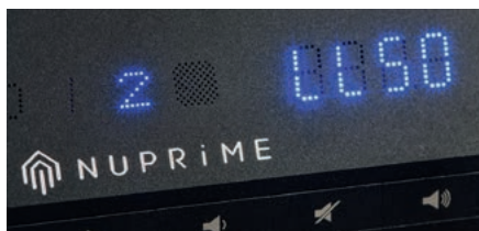
DAC-10H ma oryginalny "wyświetlacz" – diody umieszczono w mikrootworach.
