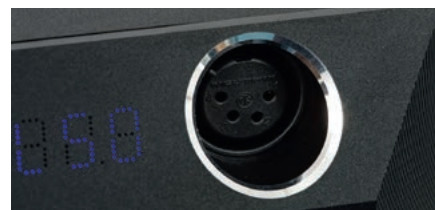
Wersja "H" oznacza obecność wzmacniacza słuchawkowego, wyjścia są nawet dwa – jedno z nich to symetryczne gniazdo XLR-4.
