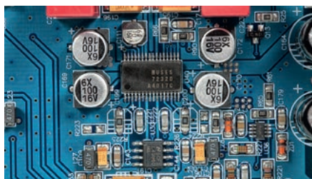
Regulację głośności powierzono scalonej drabince JRC 72320 z prestiżowej linii Muses.
