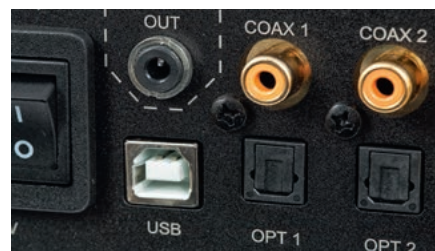
Wejście USB przyjmuje sygnały PCM 24/384 oraz DSD256.
