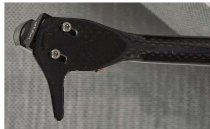
Rurka jest na końcu „przeformowana” w integralną, płaską główkę.
