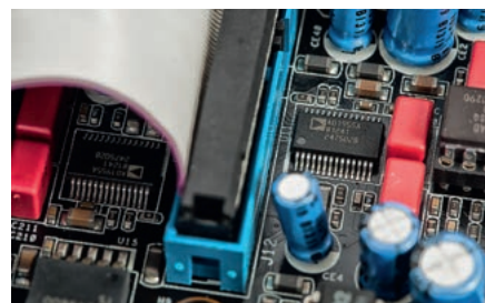
Każdy kanał ma swój własny, stereofoniczny przetwornik C/A – Analog Devices AD1955.
