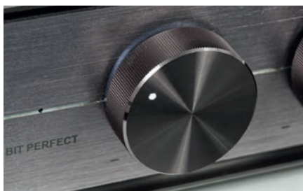
Odpowiednią sekcję (słuchawki/wyjście liniowe) wybieramy przyciskiem, co potwierdza dioda oraz podświetlony pierścień wokół jednego z dwóch pokręteł regulacji głośności.
