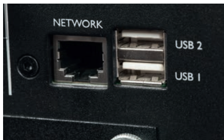
Połączenie sieciowe możliwe jest tylko przez kabel LAN
