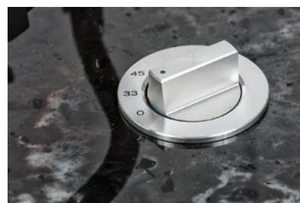
TN-550, jako jedyny gramofon w tej stawce, wyposażono w elektroniczny przełącznik obrotów.
