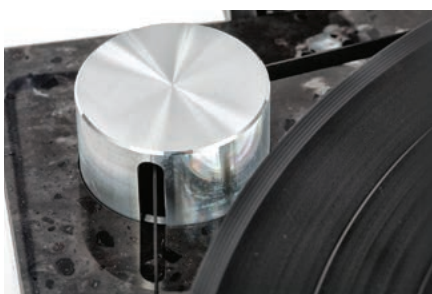
Rollka napędowa ma metalową osłonę. Nie tylko wygląda to dobrze, ale również zapobiega osiadaniu kurzu na elementach napędu.
