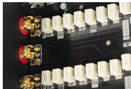
Umieszczone przy gniazdach wejściowych przełączniki załączają odpowiednie dla wybranej konfiguracji zestawu obciążeń.
