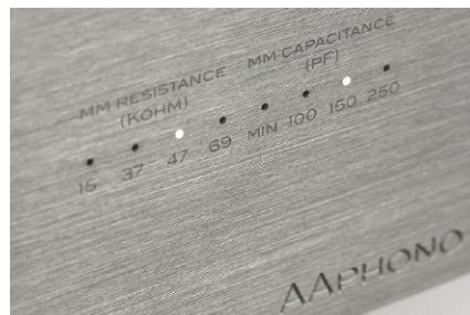
Sekcja dla wkładek MM jest niezwykle rozbudowana, oprócz typowego zestawu obciążeń pojemnościowych jest także regulacja impedancji wejściowej.
