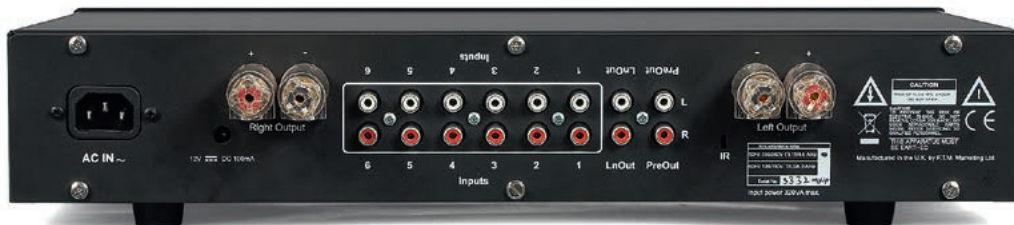
Opisy wejść wykonano podwójnie – „normalnie” i „do góry nogami”, aby były czytelne od góry.
