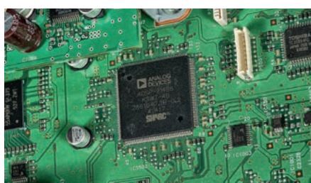
Procesory DSP to jedne z najpopularniejszych (dla tych zastosowań) układów SHARC Analog Devices.
