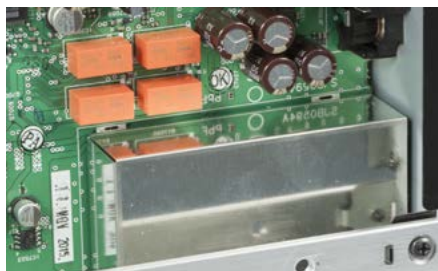
Technics zadbał o warunki pracy przedwzmacniacza gramofonowego, umieszczając jego układy wewnątrz metalowej puszkii.
