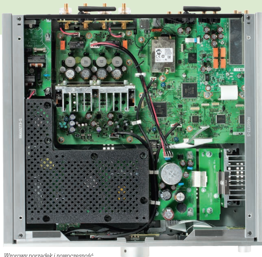
Wzorowy porządek i nowoczesność, impulsowe końcówki mocy zajmują niewiele miejsca i nie wymagają dużych radiatorów.
