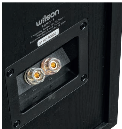
Gniazdko prozaiczne, widać też typowe dla tej klasy, bardzo tradycyjne wykonanie obudowy - z tylną ścianką „wkładaną” między pozostałe.
