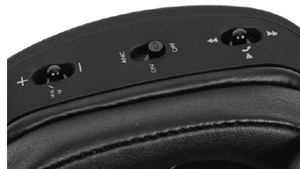
Manipulatory podzielono na trzy sekcje – w każdej znajduje się hebelek.
