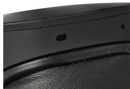
Za niewielkimi szczelinami ukrywają się mikrofony, niezbędne dla systemu ANC.
