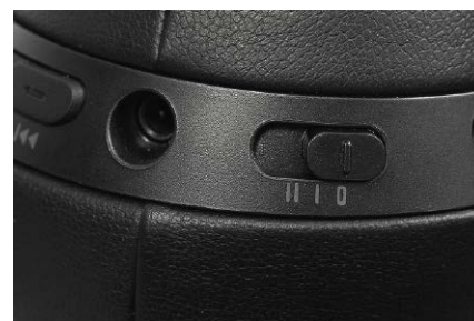
Do głównego włącznika zasilania dodano trzecią pozycję – systemu redukcji hałasu ANC.
