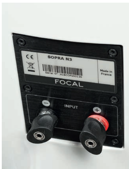
Sopra 3, tak jak wiele high-endowych konstrukcji, wcale nie pozwala na zastosowanie bi-wiringu czy bi-amping; tego typu zabawy są już „niepoważne” na tym poziomie jakości?
