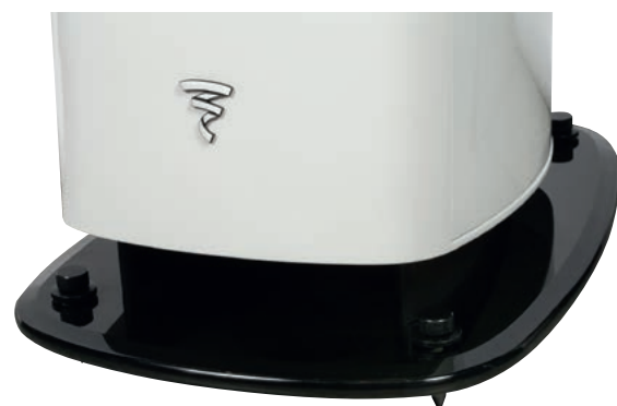
Cokół wykonano z 2-centymetrowego szkła; właściwa obudowa jest podniesiona i pochylona za pomocą pary podpór, tworzących jednocześnie przedłużenie tunelu bas-refleks.
