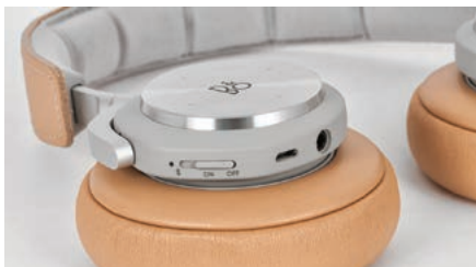
H7 mają tylko jeden mechaniczny suwak – do włączania słuchawek i aktywacji parowania BT.
