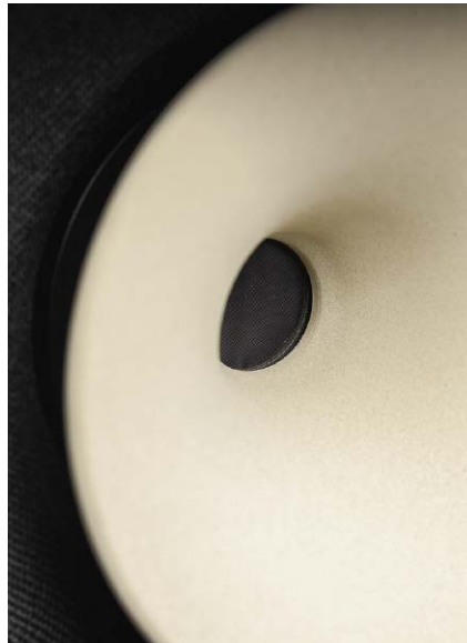
Wlot tuby wysokotonowej jest zasłonięty siateczką, nie widać membrany.
