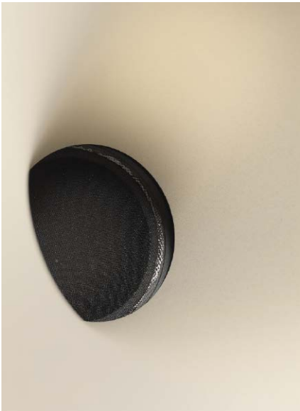
We wlocie tuby średniotonowej widać wypukłą część membrany przetwornika.
