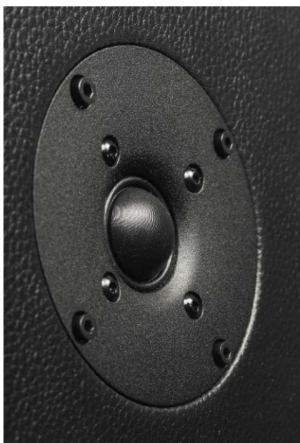
Jednocalowa, tekstylna kopułka wysokotonowa wygląda raczej standardowo, ale w pomiarach i próbach odsłuchowych udowodniła swoją wysoką jakość.
