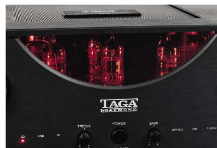
Za wycięciem we froncie widać komorę lamp w sekcji przedwzmacniacza.
