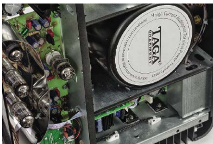
Wewnętrzne wieńce nie tylko wzmacniają obudowę, ale pełnią też rolę ekranów.
