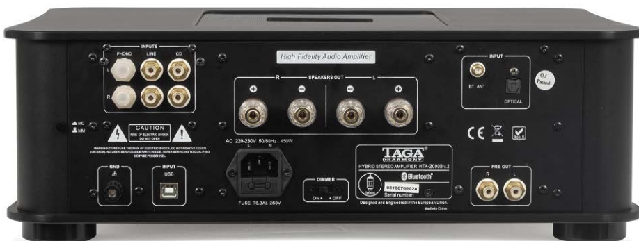
Układ gniazd jest trochę nietypowy, zwłaszcza w ramach sekcji cyfrowej – z jednej strony znajduje się USB, a z drugiej wejście optyczne.
