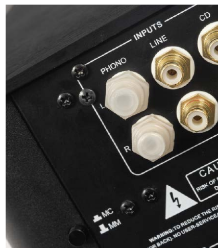
Szczególnym osiągnięciem jest wejście na gramofon – pracuje zarówno z wkładkami MM, jak też MC.
