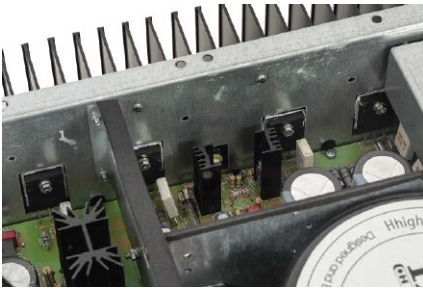
W końcówkach mocy zastosowano dwie pary tranzystorów bipolarnych.
