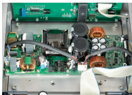
Końcówki mocy zmontowano na jednej płytce, tranzystory przełączające przykręcono do dolnej ścianki poprzez grubą płytę dystansującą.
