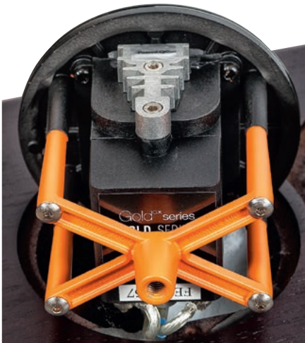
Konstrukcję głośnika wysokotonowego uzupełniono o specjalny stelaż, potrzebny do wykonania nietypowej instalacji.
