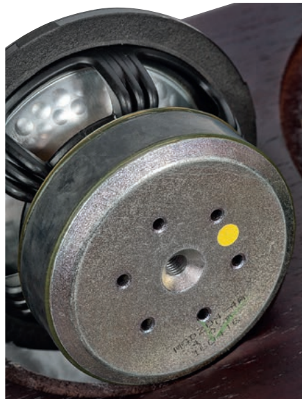
Głośnik średniotonowy – również tutaj układ magnetyczny jest wentylowany sześcioma otworami, jako że w miejscu otworu centralnego przygotowano gwint na śrubę mocującą.
