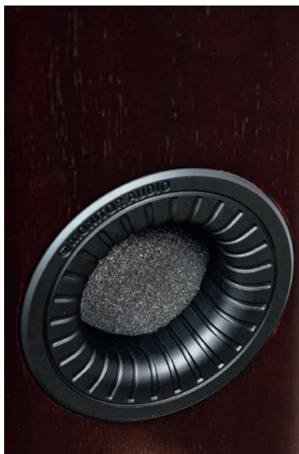
Tunel bas-refleks, jak na pracę z parą 18-cm niskotonowych, ma małą średnicę (4 cm). Na wyposażeniu jest też zatyczka, która pozwala zamienić system w zamknięty.
