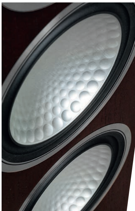
Przetłoczenia membran głośników to nie tylko dekoracja (chociaż, owszem, projektanci na pewno i to wzięli pod uwagę), ale technicznie elegancki (bo prosty!) sposób na ich usztywnienie – bez zwiększania masy.
