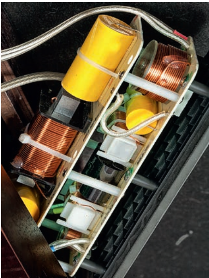
Konstrukcję głośnika wysokotonowego uzupełniono o specjalny stelaż, potrzebny do wykonania nietypowej instalacji.
