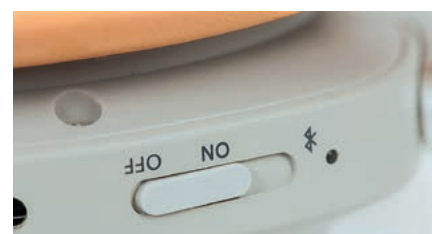
Włącznik zasilania jest jedynym tradycyjnym manipulatorem.
