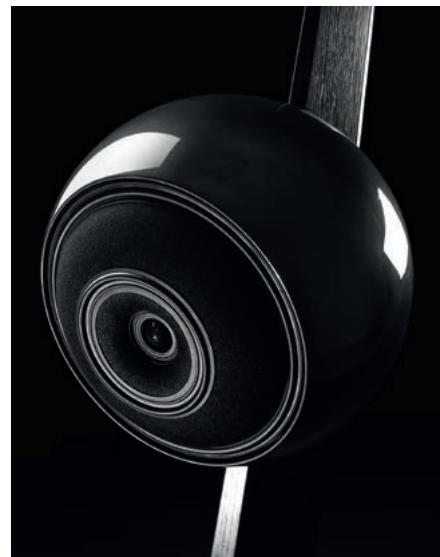
Nowa wersja – Baltic 4 . Kopułka wysokotonowa „siedzi” w wierzchołku stożka membrany „wyższego środka” (podobnie jak np. w Uni-Q ); układ wygląda na prostszy, ale dzięki temu... ma mniej wystających krawędzi, co prowadzi do wyeliminowania przynajmniej części rezonansów powstających na skutek odbić. Membrana przetwornika „niskiego środka” pozostaje w formie ćwiartki torusa. Cały układ, wraz z kulą obudowy, prezentuje bardzo dobre warunki do uzyskania szerokich i stabilnych charakterystyk kierunkowych. Membrany przetworników średniotonowych wykonano z plecionki aramidowej (znanej lepiej jako Kevlar, ale to nazwa zastrzeżona przez koncern DuPont).
