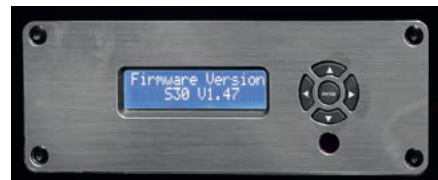
Santorin 30-500 jest wyposażony we frontowy panel z wyświetlaczem, zdalne sterowanie i system korekcji charakterystyki (niezależny od obowiązkowych, podstawowych regulacji). Prawie dwa razy tańszy Santorin 230-200 nie ma tych elementów, a jego wzmacniacz ma tylko 200 W (zamiast 500 W); obudowa i głośnik są jednak takie same.
