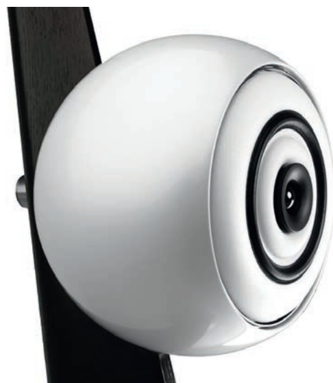
Poprzednia wersja Baltic Evo ; kopułka wysokotonowa – podobnie jak w wielu ówczesnych konstrukcjach Cabasse – ma własną, krótką tubkę (element czarny), która znajduje się przed membraną przetwornika „wyższego środka” (biała połówka torusa). Wadą tego rozwiązania jest krawędź tubki, od której odbijają się fale pochodzące od obydwo sąsiadujących z nią przetworników. Membrany obydwu przetworników średniotonowych (białe) są wykonane z charakterystycznej, firmowej pianki Duocell.
