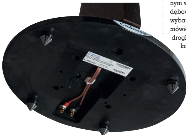
Cokoł ubzramy w kolce. Ponieważ środek ciężkości całej konstrukcji jest przesunięty względem centrum cokołu do tyłu, więc w celu uzyskania właściwej stabilności kolce też są przesunięte (nie znajdują się w wierzchołkach kwadratu wpisanego w okrąg cokołu).
