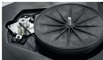
Układ napędowy ulokowano pod talerzem, zwraca uwagę sposób odsprężnienia silnika, który jest zawieszony na gumowym „szkielecie”.
