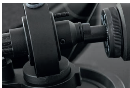
Rurka ramienia wchodzi w tubus i jest blokowana za pomocą niewielkiej śrubki, jej poluzowanie umożliwi regulację azymutu wkładki (kręcimy całą rurką ramienia).
