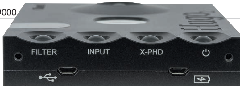
Gniazda USB są dwa – jedno do ładowania akumulatorów, drugie dla sygnałów audio.
