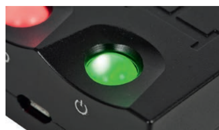
Najbardziej kolorowa, przechodząca w płynny sposób między barwami i odcieniami, jest sferyczna regulacja wzmocnienia. Kolor czerwony – gramy cicho; zielony – głośno; biały – bliski ustawienia maksymalnego.
