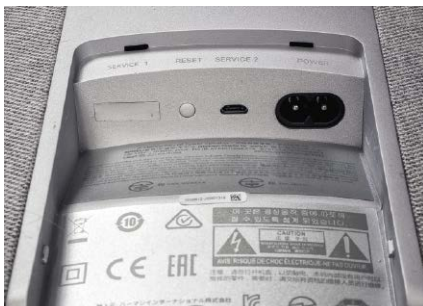
Jedna z kolumn ma panel sterowania, ale obydwie niezależne wzmacniacze. Citation Tower nie ma żadnych przewodowych wejść audio.
