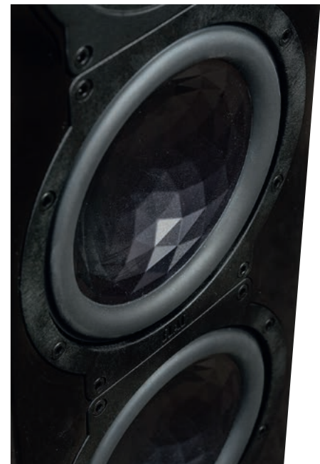
Membrany „kryształowe”, ze względu na swoją strukturę, zapewniającą przede wszystkim wysoką sztywność, a nie niską masę, wydają się najlepszym wyborem do głośników niskotonowych, chociaż Elac stosuje je „wszędzie”, oczywiście z wyjątkiem głośników wysokotonowych.
