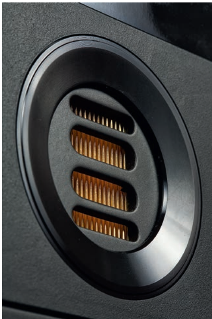
JET Elaca to firmowa wersja przetwornika typu AMT; widać fałdy membrany niewystępujące w „zwykłym” przetworniku wstęgowym. Mała powierzchnia AMT zapewnia jednak wysokie ciśnienie, dzięki większej prędkości ruchu cząsteczek powietrza, niżby to wynikało z prędkości ruchu samej membrany... Jak to możliwe? Tak jak strumień moczu ma prędkość większą niż prędkość ruchu ścianek pęcherza. Howgh.
