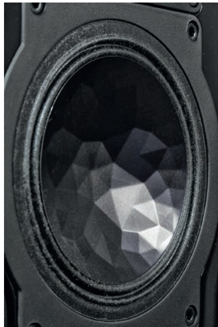
15-cm głośnik średniotonowy ma piękną, „kryształową” membranę, ale w tym przypadku warto też zwrócić uwagę na zawieszenie – niewielką fałdę z pianki (zamiast większą z gumy), właściwą dla wysoce wyspecjalizowanych przetworników średniotonowych, które nie są przeznaczone do pracy z dużymi amplitudami.
