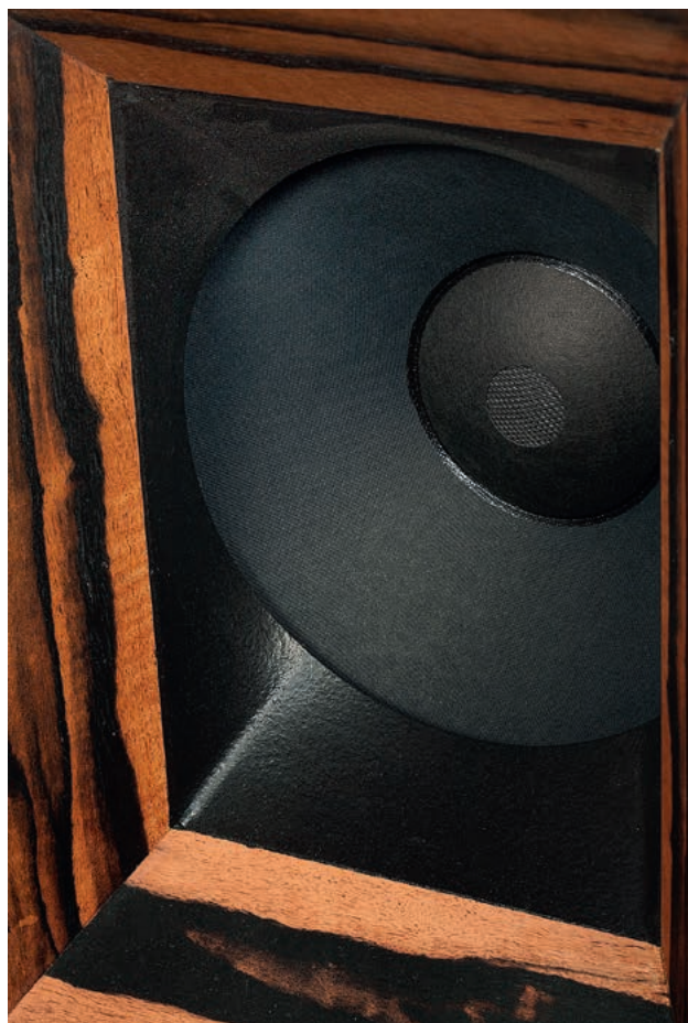
Sam głośnik niskotonowy jest zasadniczo konwencjonalnym wooferym, pracującym w obudowie bas-refleks, dodanie tubowego wylotu zwiększyło efektywność w zakresie od 100 Hz wzwyż.
