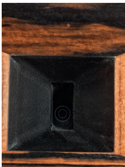
Za 35-mm wlotem tuby znajduje się komora kompresyjna, a w niej „driver” z tytanową membraną o średnicy aż 75 mm. Nic dziwnego, że taki głośnik może swobodnie pracować od ok. 1 kHz.
