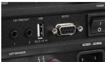
Złącze USB-A to wyłącznie źródło zasilania dla dodatkowego osprzętu (np. modułu Wi-Fi).
