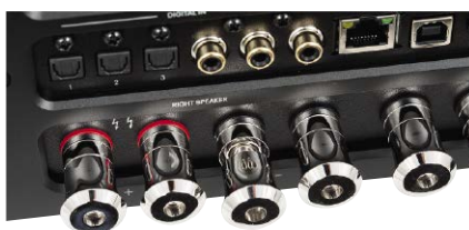
Terminale głośnikowe są podwójne i bardzo wygodne, choć trzeba uważać na dość nietypowy układ trzpieni + i -.
