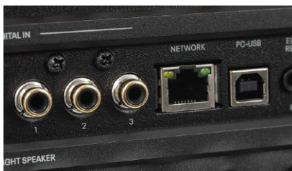
W sekcji cyfrowej najwartościowsze jest wejście USB z funkcją USB-DAC; gniazdo sieciowe LAN służy tylko do sterowaniem.
