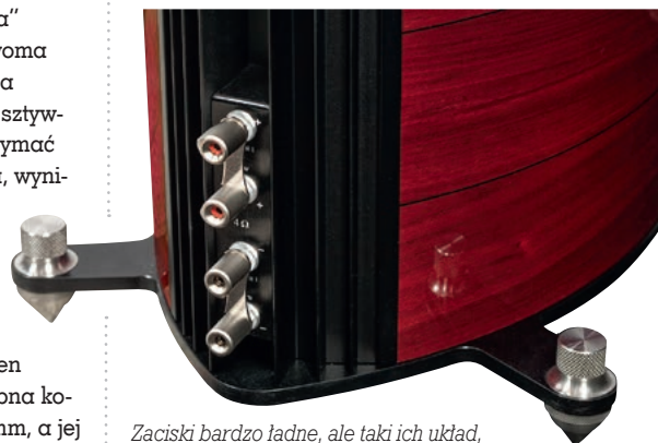
Zaciski bardzo ładne, ale taki ich układ, wymuszony szczupłością miejsca, wymaga ostrożności – łatwo o pomyłkę i zwarcie wyjść wzmacniacza.
