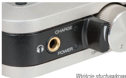
Wyjście słuchawkowe dla „nauszników” o impedancji w zakresie od 16 do 600 Ω może także służyć jako wyjście liniowe (do podłączenia wzmacniacza).
