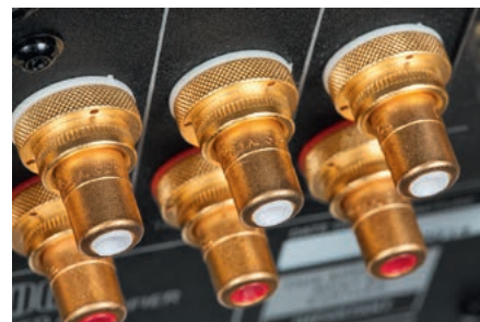
Grube kołnierze gniazd RCA wkręcono w tylną ściankę, nie sposób tu niczego wyłamać, nawet stosując najcięższe interkonekty.
