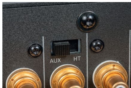
Jedno z wejść liniowych można przełączyć w tryb integracji z procesorem wielokanałowym, wchodząc wówczas bezpośrednio na końcówki mocy.
