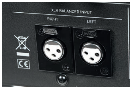
Wzmacniacz nie jest konstrukcją zbalansowaną, wejście XLR prowadzi sygnał do układów desymetryzujących.
