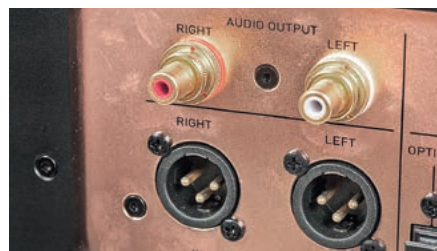
Wyjścia analogowe przygotowano w standardach RCA i XLR, ale nuwistory pracują tylko w torze RCA.
