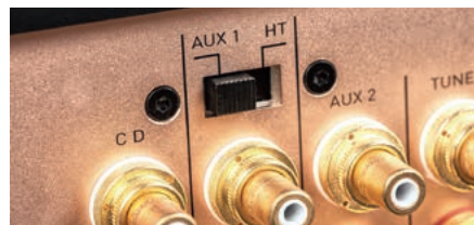
Jedno z wejść liniowych (we wzmacniaczu) ma tryb bypass (do integracji np. z kinem domowym), wyboru dokonujemy przełącznikiem.
