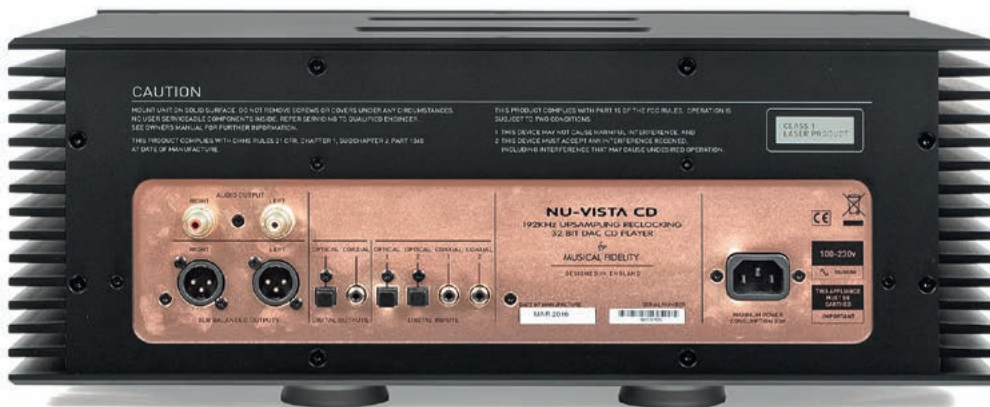
Effektywne radiatory sięgają również do tylnej ścianki, chociaż w odtwarzaczu pełnią rolę wyłącznie ozdobną.
