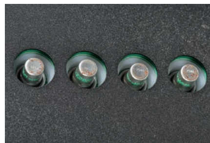
Gniazda nuwistorów zostały obudowane pierścieniami z diodami LED, aby wyeksponować te bardzo niepozorne elementy i nadać im „lampowy” charakter.
