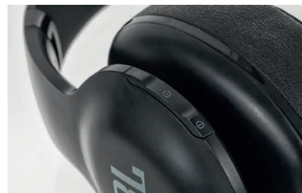
W panelu regulacji środkowy przycisk pełni rolę wielofunkcyjnego sterownika, trzeba jednak opanować szereg kombinacji naciśnień.
