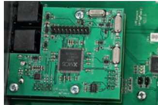
Obsługa wejścia USB przebiega w oddzielnym module z procesorem XMOS.
