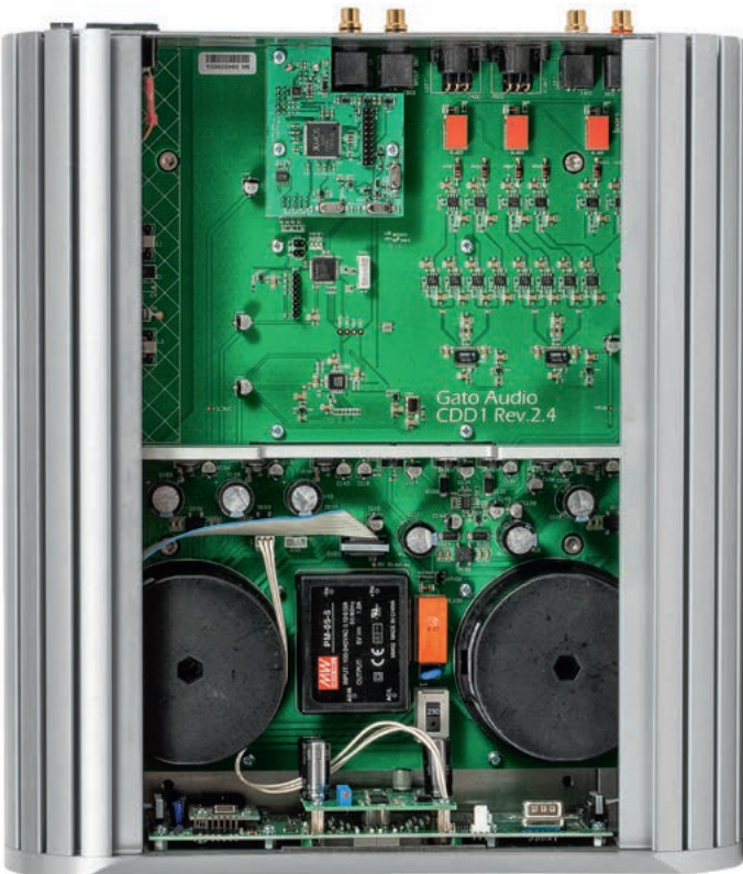
We wnętrzu znajdują się, nie licząc samego mechanizmu, który jest zamocowany w górnej płycie, trzy główne bloki – rozbudowane zasilanie, sterowanie mikroprocesorowe oraz, w tylnej komorze, sekcja audio.
