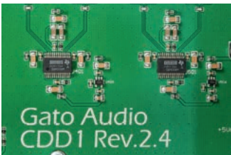
Przetworniki C/A w konfiguracji dual-mono, a w każdym kanale znajduje się stereofoniczny konwerter, aby już na tym etapie wygenerować sygnał zbalansowany.
