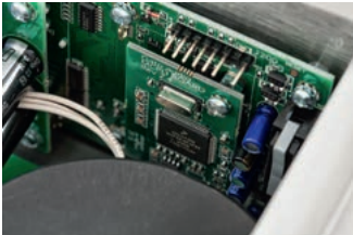
Sterowaniem wszystkimi funkcjami CDD-1 zajmuje się procesor Motorola Coldfire.
