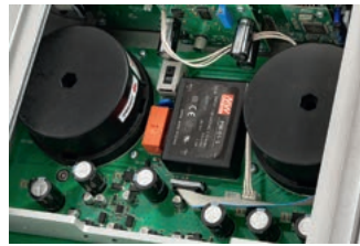
W rozbudowanym zasilaczu pracują aż trzy transformatory sieciowe.
